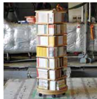
地震時の安全性を検証するため、振動台による加振実験を行っています。
