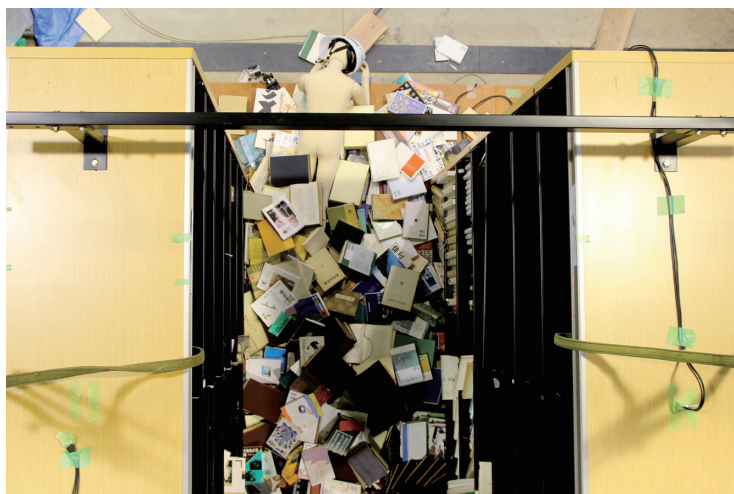
書架2列の通路間における加振実験 ※写真上部の人物はマネキンです。
